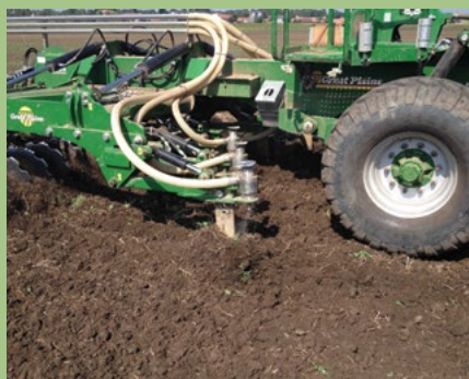
Vlastní hnojiva jsou aplikována v dráze podryvacích slupic.
