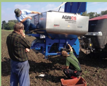
Kalibrace hnojení pod patu se provádí podobně jako nastavení výsevku.
